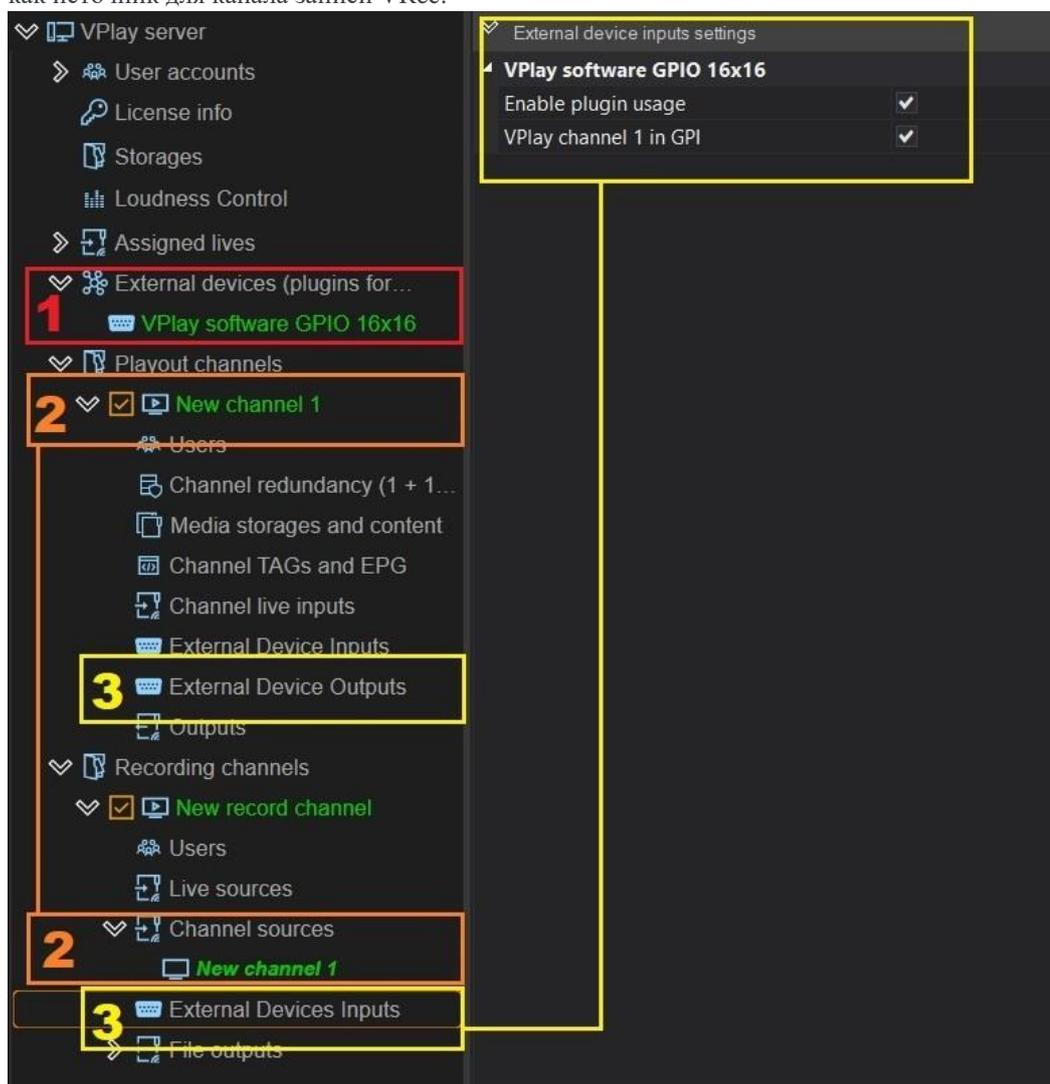
**Рисунок 101. Активация Soft GPI для каналов воспроизведения и записи**
