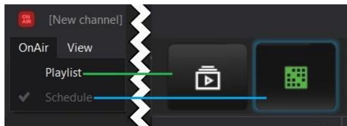
Рисунок 218. Переключение режима работы канала
