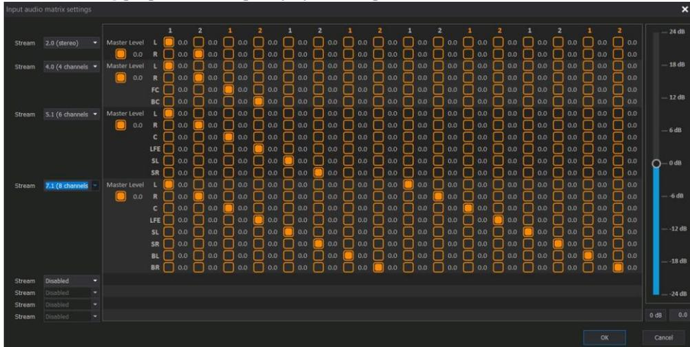
**Рисунок 55. Настройка аудио матрицы входного сигнал**
